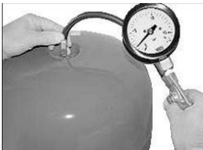
Рис. 10 Контроль давления в мембранном баке
