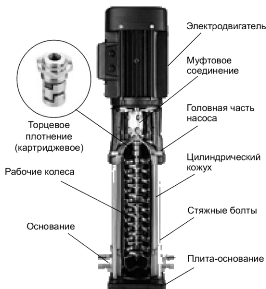
Рис. 5 Конструкция насоса CDL/CDLF
