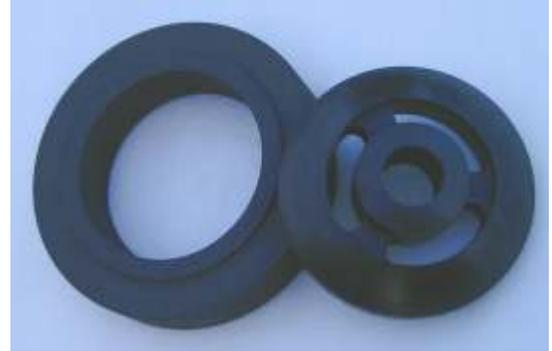
Седла шаровых клапанов, главным образом, используются для обеспечения уплотнения в клапанах, в которых требуется герметизация горячих газов, пара или горячих жидкостей. Седла, изготовленные из углеродного графита, являются химически инертными, огнестойкими и пригодными для применения в условиях высоких температур. Преимущественно используются в химической промышленности, нефтяных танкерах и нефтеперерабатывающих предприятиях.
