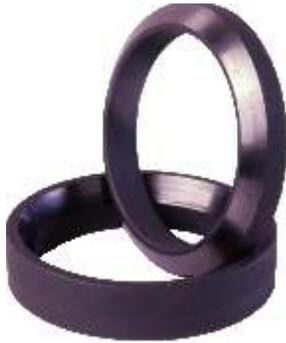
Соединительные кольца, изготовленные из углеродного графита, в основном, используются во вращающихся соединениях для ввода пара, воды или газов во вращающемся оборудовании, например, в роликах или цилиндрах. Функцией данных колец является уплотнение и в то же время компенсация вибраций и объемного расширения при вращении.
